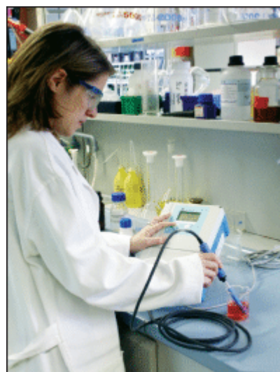
Obr. 3. Prevodníky MemoSens se kalibrují v referenčních podmínekách v kalibrační laboratoři
