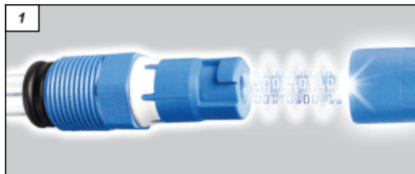
Obr. 1. Koncept Memosens: bezkontaktní digitální přenos dat i energie mezi senzorem (vlevo) a propojovacím kabelem k převodníku
