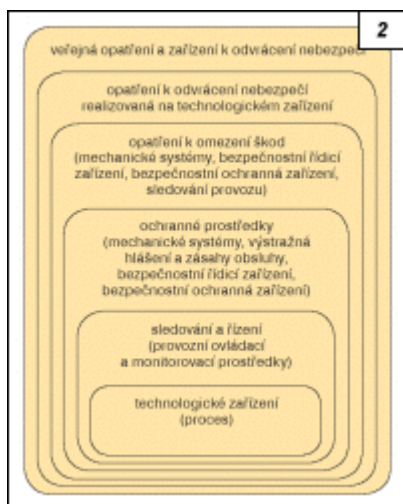
Obr. 2. Obvyklé metody zmenšování rizika při zajišťování funkční bezpečnosti technologických zařízení (procesů) na přípustnou nebo nižší úroveň
