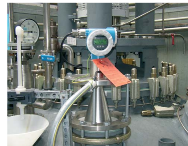
Obr.2 Neinvazívne meranie cez priezor pomocou radarového snímača Micropilot, inštalácia na Slovensku
