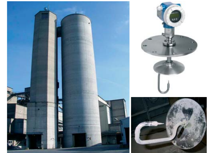
Obr.3 Meranie hladiny v cementárni pomocou radarového snímača Micropilot
