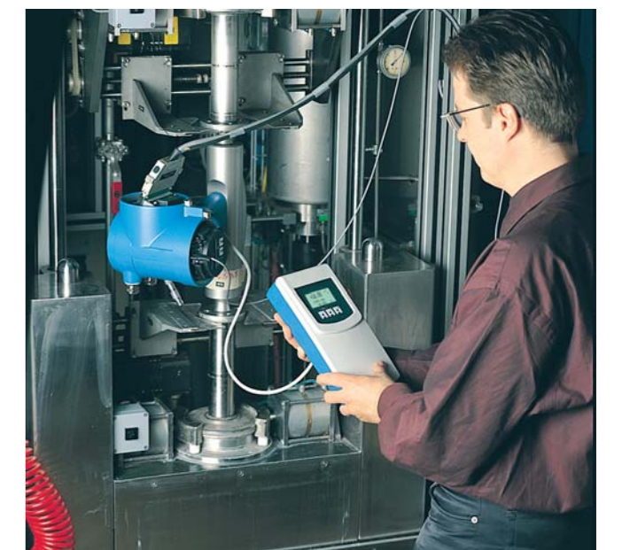
Obr.5 Verifikácia prietokomerov pomocou FieldCheck™ na mieste merania
