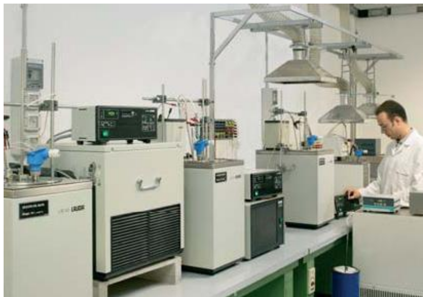
Obr. 3 Kontrola čidel teploty vyžaduje přesné dodržení podmínek měření
